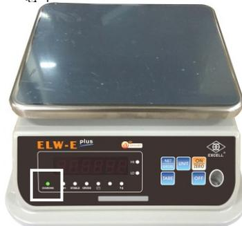
**低電源警示：**電池符號(
